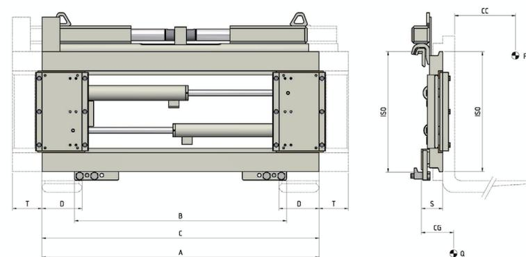
Funzioni idrauliche: 2 | Pressione max di esercizio: 80 Bar
