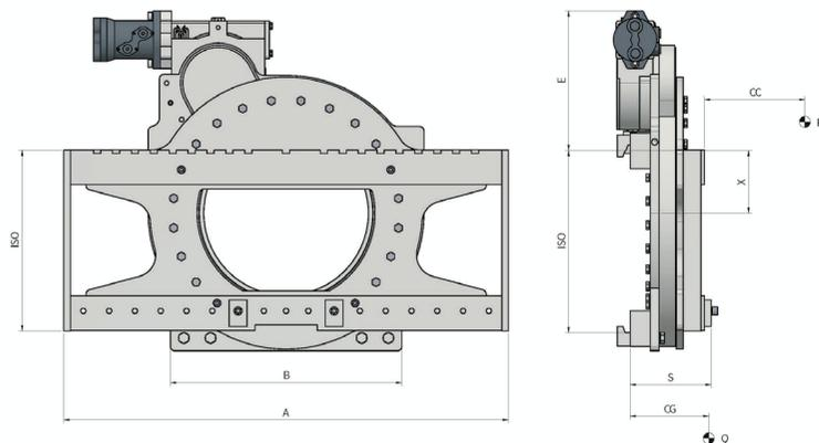
Funzioni idrauliche: 1 | Pressione max di esercizio: 175 Bar
