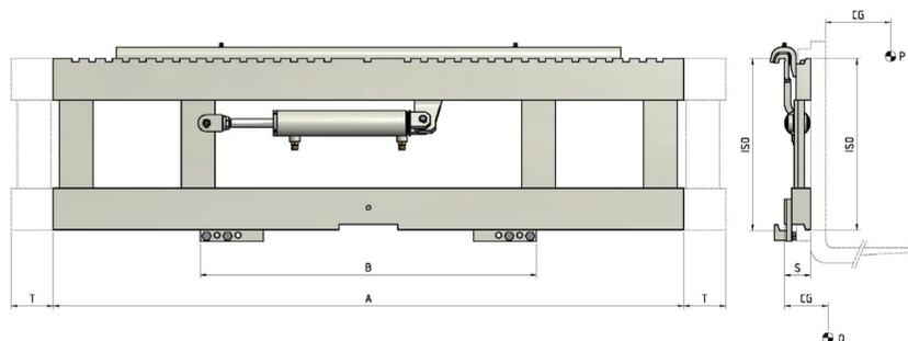
Funzioni idrauliche: 1 | Pressione max di esercizio: 200 Bar
