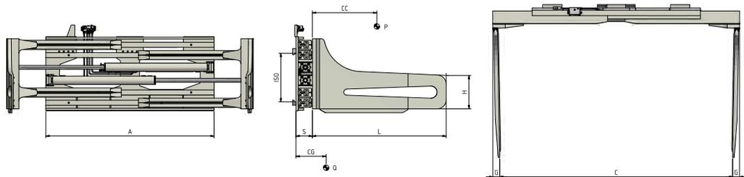
Funzioni idrauliche: 1 | Pressione max di esercizio: 175 Bar
