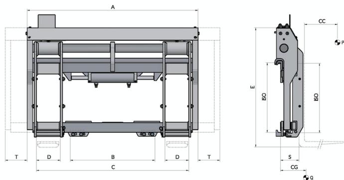
Funzioni idrauliche: 2 | Pressione max di esercizio: 110 Bar
