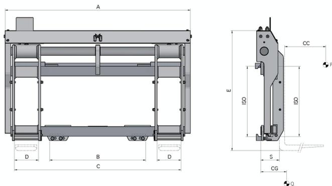
Funzioni idrauliche: 1 | Pressione max di esercizio: 110 Bar
