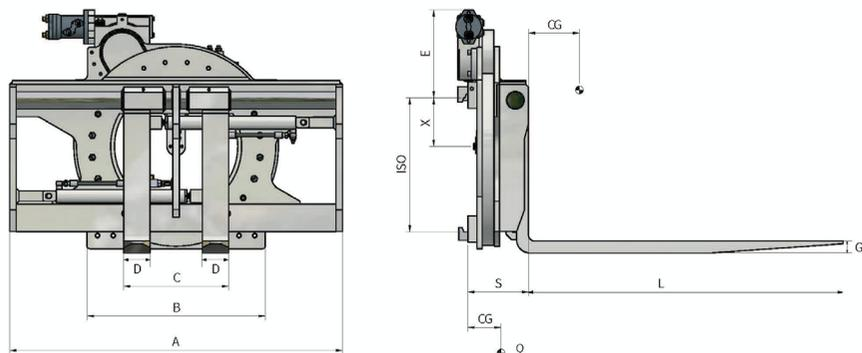
Funzioni idrauliche: 2 | Pressione max di esercizio: 175 Bar
