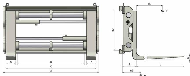
**Funzioni idrauliche: 1 | Pressione max di esercizio: 80 Bar**
