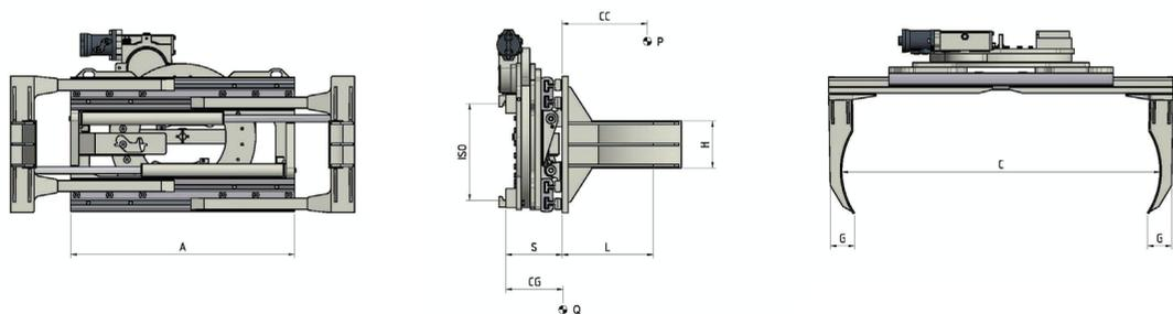
Funzioni idrauliche: 2 | Pressione max di esercizio: 175 Bar
