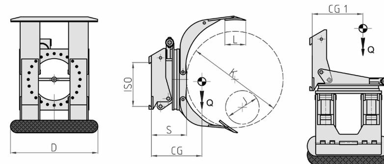
Funzioni idrauliche: 3 | Pressione max di esercizio: 175 Bar
