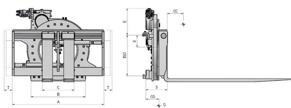
Funzioni idrauliche: 3 | Pressione max di esercizio: 175 Bar
