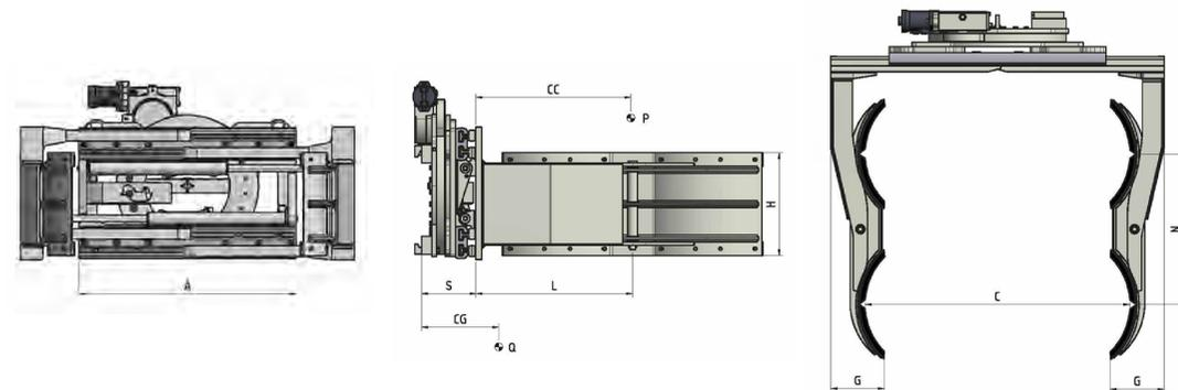
Funzioni idrauliche: 2 | Pressione max di esercizio: 175 Bar
