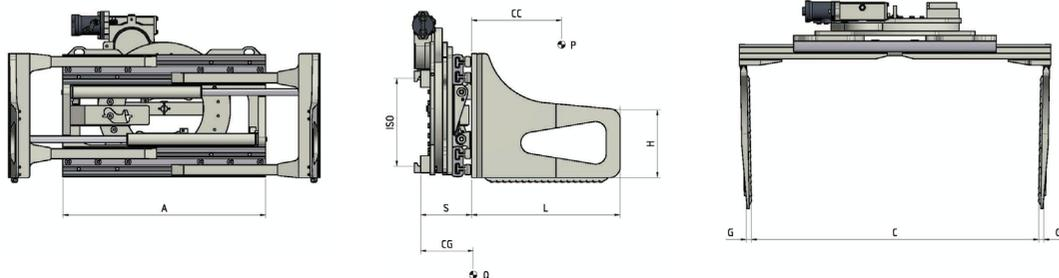
Funzioni idrauliche: 2 | Pressione max di esercizio: 175 Bar
