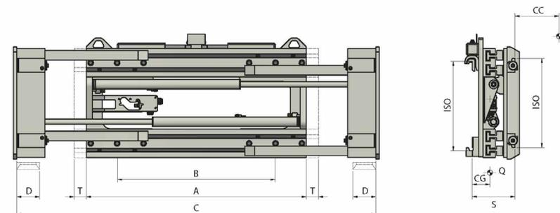
**Funzioni idrauliche: 2 | Pressione max di esercizio: 80 Bar**
