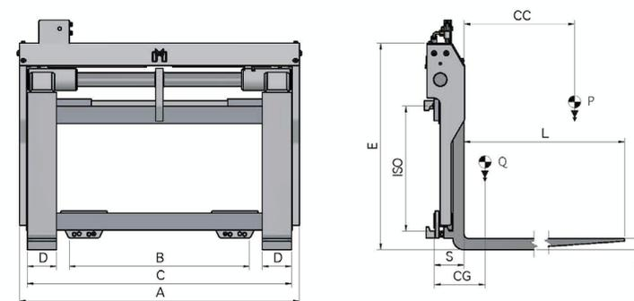
Funzioni idrauliche: 1 | Pressione max di esercizio: 110 Bar
