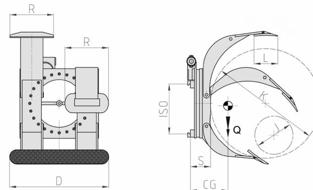
Funzioni idrauliche: 2 | Pressione max di esercizio: 175 Bar
