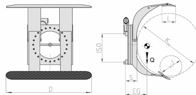
Funzioni idrauliche: 2 | Pressione max di esercizio: 175 Bar
