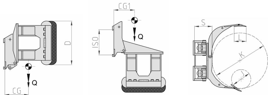
Funzioni idrauliche: 2 | Pressione max di esercizio: 175 Bar
