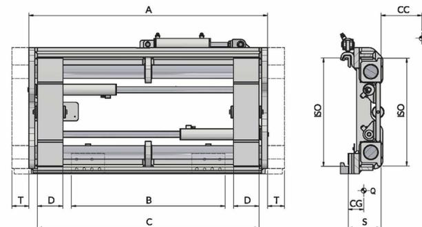
**Funzioni idrauliche: 2 | Pressione max di esercizio: 80 Bar**
