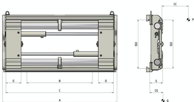
**Funzioni idrauliche: 1 | Pressione max di esercizio: 80 Bar**
