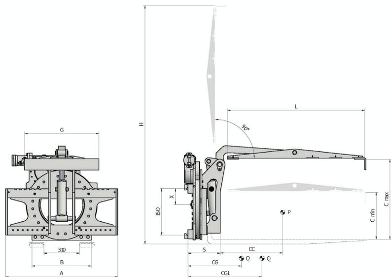
Funzioni idrauliche: 2 | Pressione max di esercizio: 175 Bar
