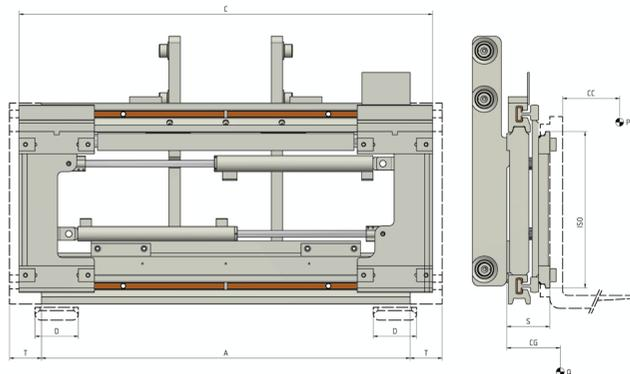
**Funzioni idrauliche: 2 | Pressione max di esercizio: 80 Bar**
