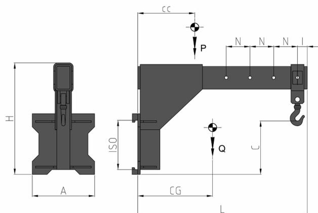
**Caratteristiche:** • Movimentazione carichi sospesi. • Impiego di Cinghie o Catene.
