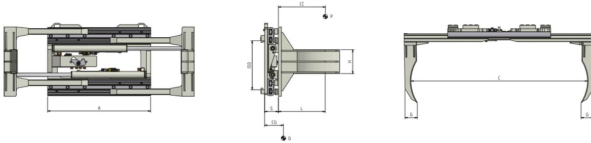
**Erforderliche Hydraulikfunktionen: 1 | Maximaler Betriebsdruck: 175 Bar**
