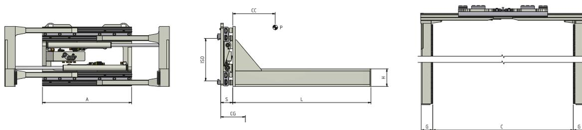
Fonctions hydrauliques: 1 | Pression max d'utilisation: 175 Bar
