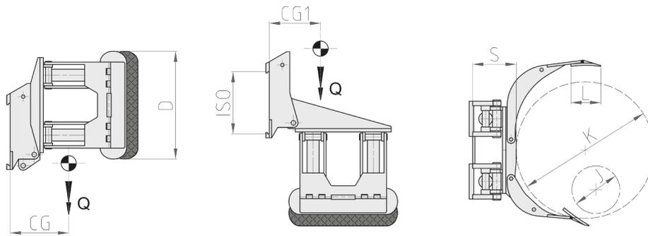
Erforderliche Hydraulikfunktionen: 2 | Maximaler Betriebsdruck: 175 Bar
