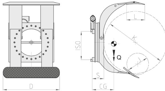
Funciones Hidráulicas: 2 | Presión Máx de Trabajo: 175 Bar
