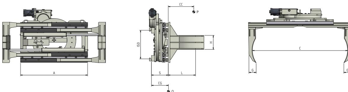
Fonctions hydrauliques: 2 | Pression max d'utilisation: 175 Bar
