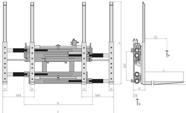
**Funciones Hidráulicas: 1 | Presión Máx de Trabajo: 200 Bar**
