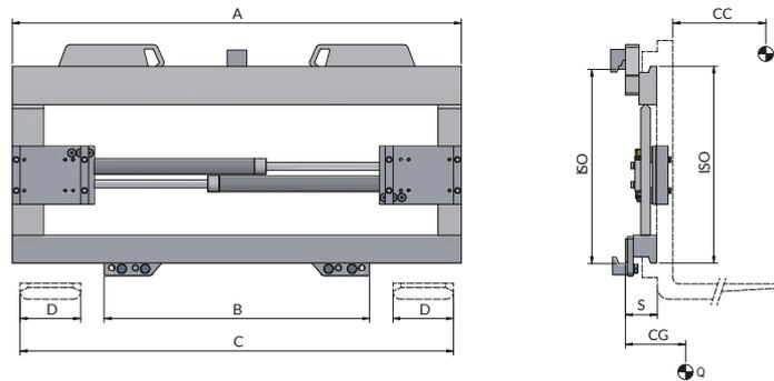
Funciones Hidráulicas: 1 | Presión Máx de Trabajo: 110 Bar
