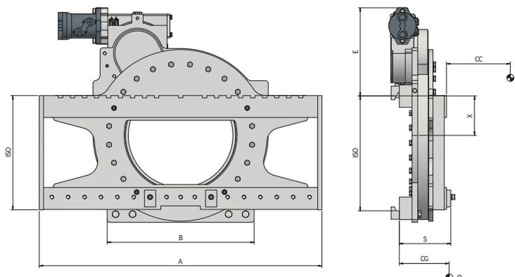
Fonctions hydrauliques: 1 | Pression max d'utilisation: 175 Bar
