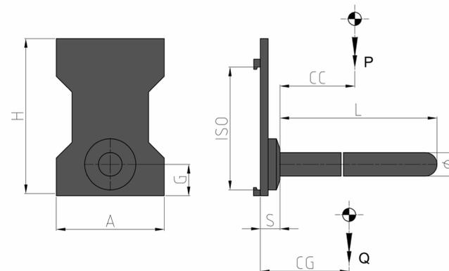
**Caractéristiques:** • Prise de charges tubulaire couchée dans le sens longitudinal par rapport à l'axe du chariot élévateur (bobines de papier, tapis, moquettes, tuyaux en plastique, ciment ou fer). • Accrochable sur le tablier d'origine du chariot élévateur.
