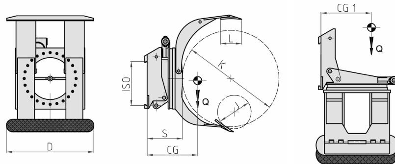
FUNCIONES HIDRÁULICAS: 3 | PRESIÓN MÁX DE TRABAJO: 175 Bar
