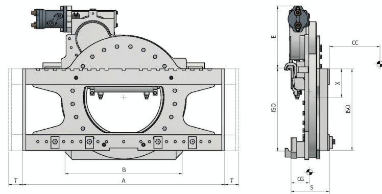
**FUNCIONES HIDRÁULICAS:** 2 | **PRESIÓN MÁX DE TRABAJO:** 175 Bar
