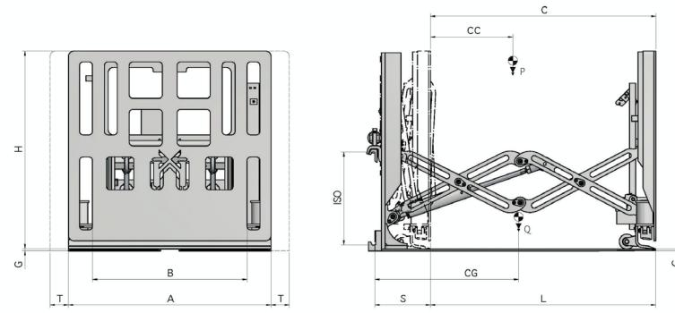
**FUNCIONES HIDRÁULICAS:** 2 + **FUNCIONES ELÉCTRICAS:** 1 | **PRESIÓN MÁX DE TRABAJO:** 175 Bar
