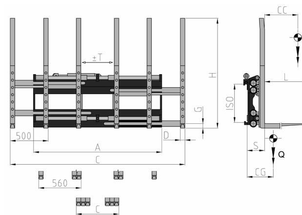
**FUNCIONES HIDRÁULICAS:** 2 | **PRESIÓN MÁX DE TRABAJO:** 200 Bar
