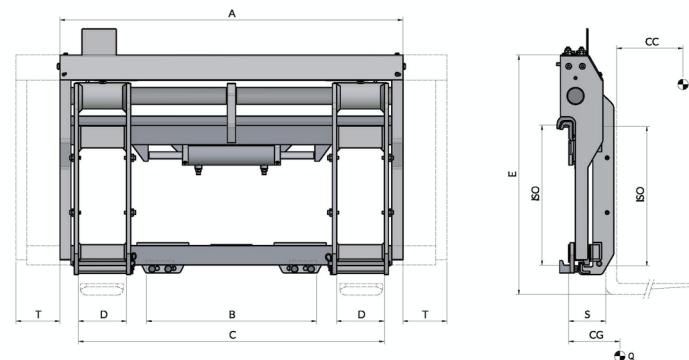
**FUNCIONES HIDRÁULICAS:** 2 | **PRESIÓN MÁX DE TRABAJO:** 110 Bar
