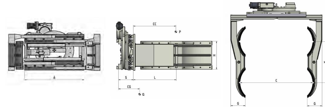
**FUNCIONES HIDRÁULICAS:** 2 | **PRESIÓN MÁX DE TRABAJO:** 175 Bar
