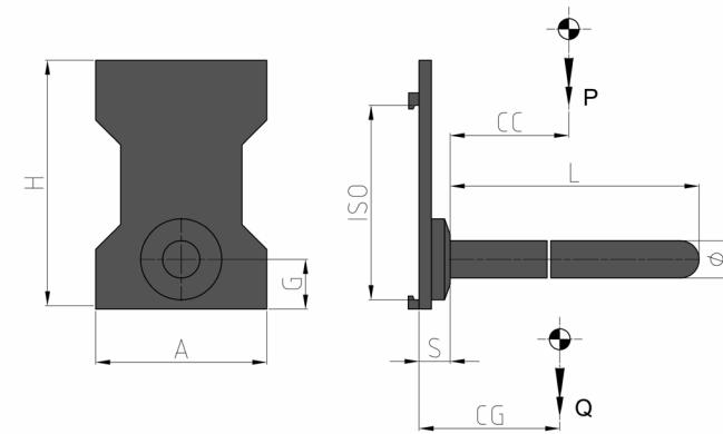
**Características:** • Toma de cargas tubulares en posición plana y longitudinal con respecto al eje de la Carretilla Elevadora (bobinas de papel, alfombras, moqueta, tubos de plástico, cemento o hierro, bobinas de alambrón). • Se puede instalar sobre la placa portahorquillas original de la Carretilla Elevadora.
