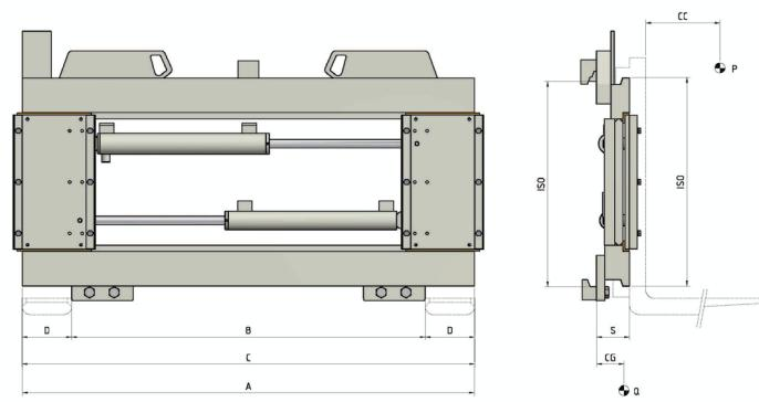
**FUNCIONES HIDRÁULICAS:** 1 | **PRESIÓN MÁX DE TRABAJO:** 80 Bar
