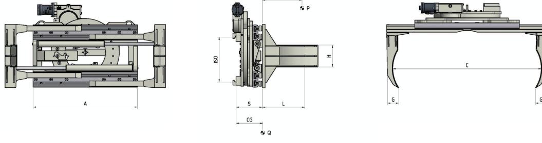
**FUNCIONES HIDRÁULICAS:** 2 | **PRESIÓN MÁX DE TRABAJO:** 175 Bar
