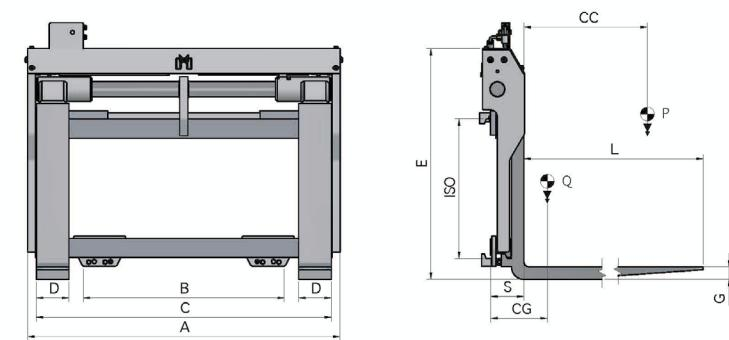
**FUNCIONES HIDRÁULICAS:** 1 | **PRESIÓN MÁX DE TRABAJO:** 110 Bar
