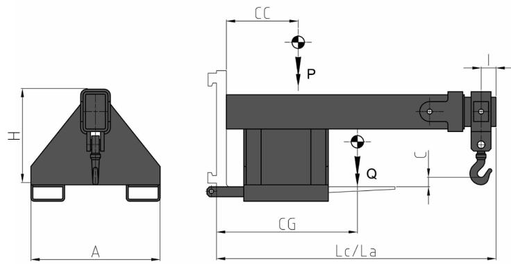
**Características:** • Implementos sobre horquillas. • Manipulación de cargas suspendidas. • Utilización de Correas o Cadenas.
