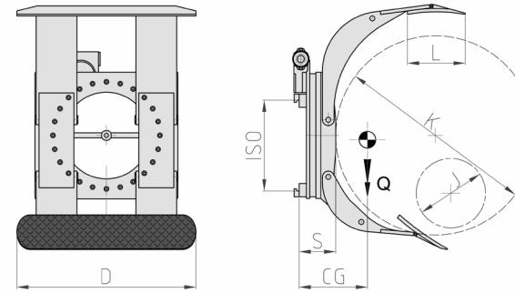
**FUNCIONES HIDRÁULICAS:** 2 | **PRESIÓN MÁX DE TRABAJO:** 175 Bar
