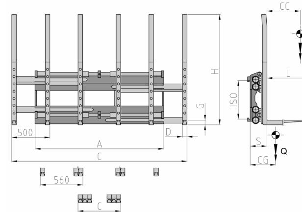
**FUNCIONES HIDRÁULICAS:** 1 | **PRESIÓN MÁX DE TRABAJO:** 200 Bar
