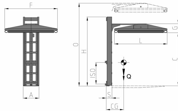
**FUNCIONES HIDRÁULICAS:** 1 | **PRESIÓN MÁX DE TRABAJO:** 175 Bar
