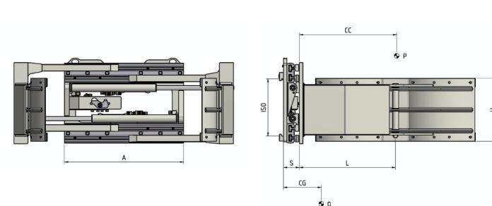
**FUNCIONES HIDRÁULICAS:** 1 | **PRESIÓN MÁX DE TRABAJO:** 175 Bar
