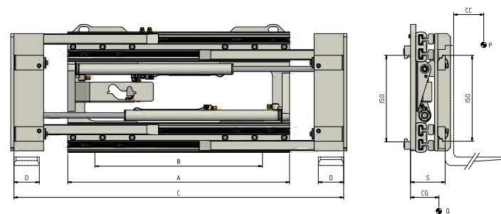
**FUNCIONES HIDRÁULICAS:** 1 | **PRESIÓN MÁX DE TRABAJO:** 80 Bar
