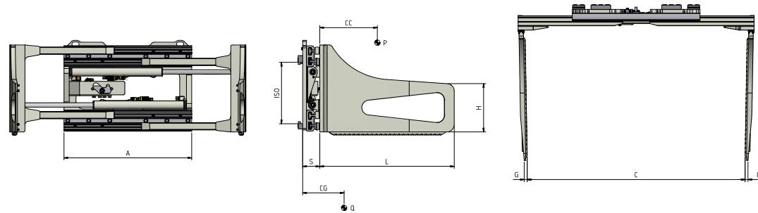
**FUNCIONES HIDRÁULICAS:** 1 | **PRESIÓN MÁX DE TRABAJO:** 175 Bar
