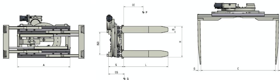
**FUNCIONES HIDRÁULICAS:** 2 | **PRESIÓN MÁX DE TRABAJO:** 175 Bar
