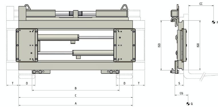
**FUNCIONES HIDRÁULICAS:** 2 | **PRESIÓN MÁX DE TRABAJO:** 80 Bar
