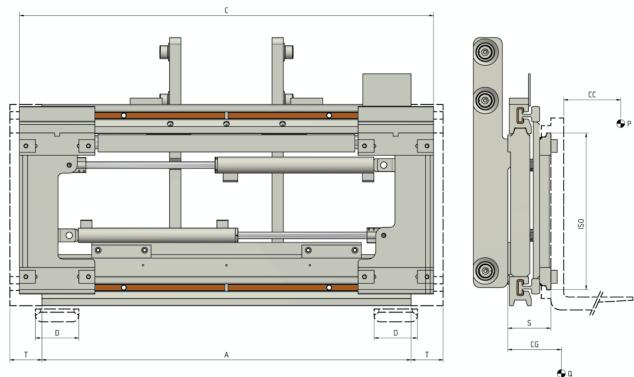
**FUNCIONES HIDRÁULICAS:** 2 | **PRESIÓN MÁX DE TRABAJO:** 80 Bar
