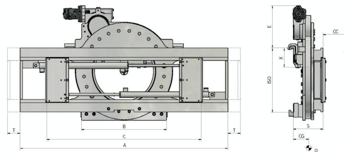
**FUNCIONES HIDRÁULICAS:** 3 | **PRESIÓN MÁX DE TRABAJO:** 175 Bar
