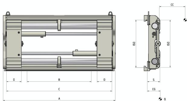
**FUNCIONES HIDRÁULICAS:** 1 | **PRESIÓN MÁX DE TRABAJO:** 80 Bar
