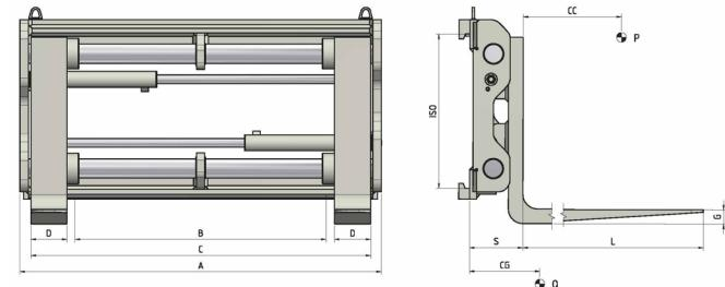
**FUNCIONES HIDRÁULICAS:** 1 | **PRESIÓN MÁX DE TRABAJO:** 80 Bar
