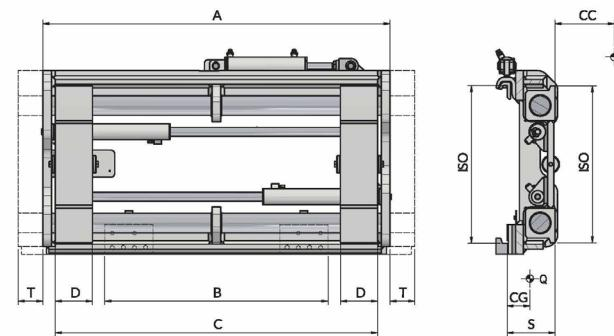
**FUNCIONES HIDRÁULICAS:** 2 | **PRESIÓN MÁX DE TRABAJO:** 80 Bar
