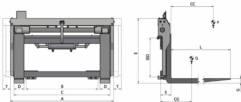
**FUNCIONES HIDRÁULICAS:** 2 | **PRESIÓN MÁX DE TRABAJO:** 110 Bar
