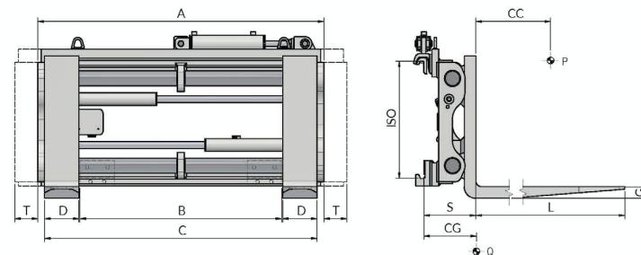
**FUNCIONES HIDRÁULICAS:** 2 | **PRESIÓN MÁX DE TRABAJO:** 80 Bar
