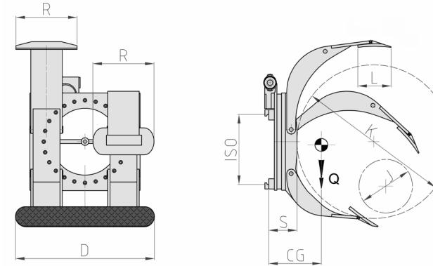
FUNCIONES HIDRÁULICAS: 2 | PRESIÓN MÁX DE TRABAJO: 175 Bar
