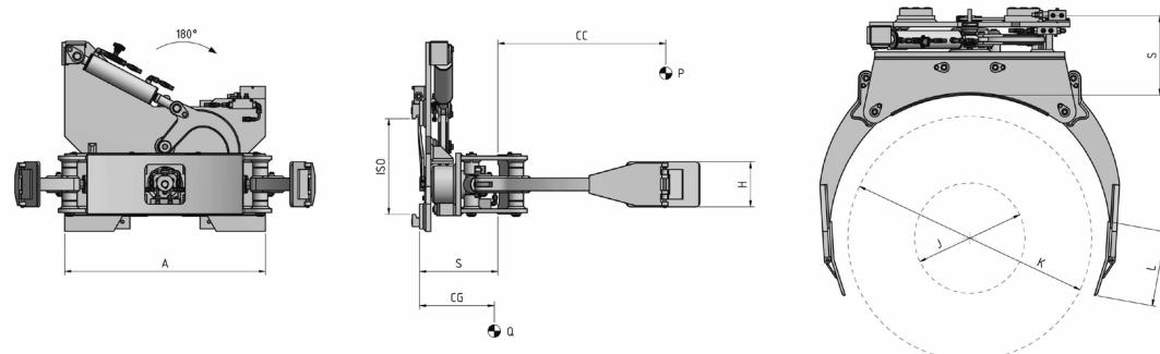
**FUNCIONES HIDRÁULICAS:** 2 | **PRESIÓN MÁX DE TRABAJO:** 175 Bar
