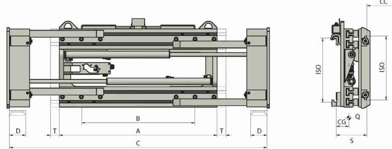
**FUNCIONES HIDRÁULICAS:** 2 | **PRESIÓN MÁX DE TRABAJO:** 80 Bar
