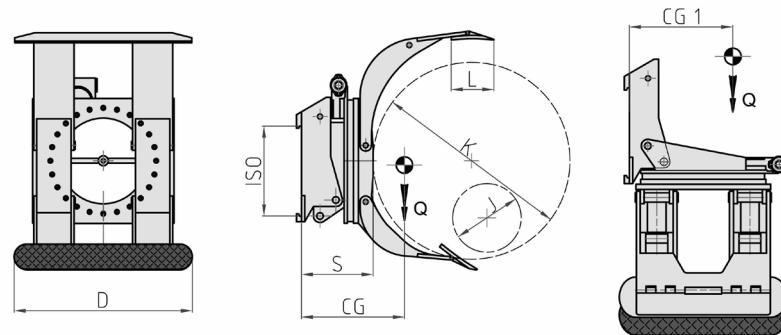
FUNCIONES HIDRÁULICAS: 3 | PRESIÓN MÁX DE TRABAJO: 175 Bar
