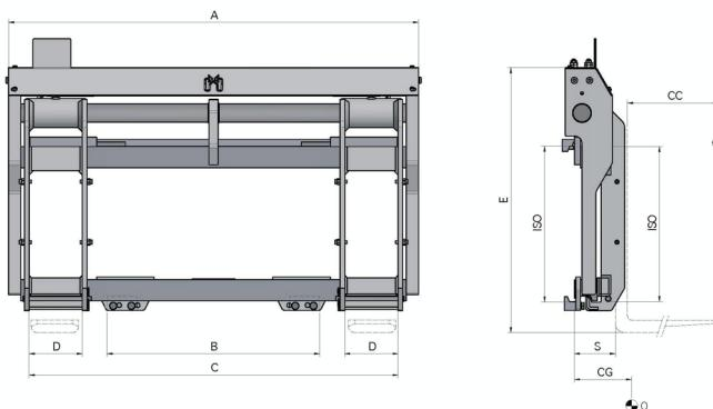
**FUNCIONES HIDRÁULICAS:** 1 | **PRESIÓN MÁX DE TRABAJO:** 110 Bar
