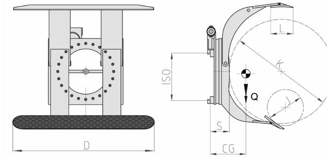
**FUNCIONES HIDRÁULICAS:** 2 | **PRESIÓN MÁX DE TRABAJO:** 175 Bar
