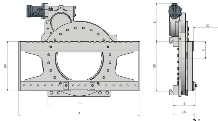
**FUNCIONES HIDRÁULICAS:** 1 | **PRESIÓN MÁX DE TRABAJO:** 175 Bar
