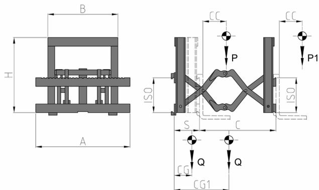
ERFORDERLICHE HYDRAULIKFUNKTIONEN: 1 | MAXIMALER BETRIEBSDRUCK: 175 Bar
