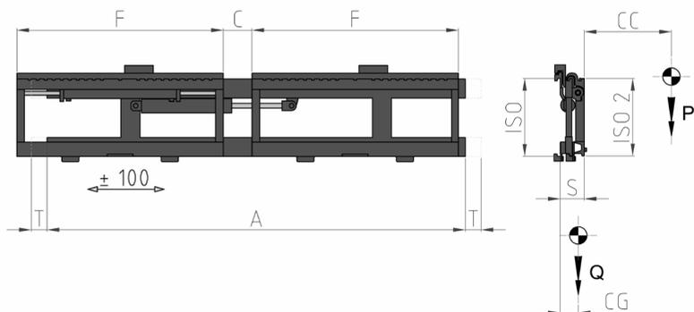
ERFORDERLICHE HYDRAULIKFUNKTIONEN: 2 | MAXIMALER BETRIEBSDRUCK: 200 Bar
