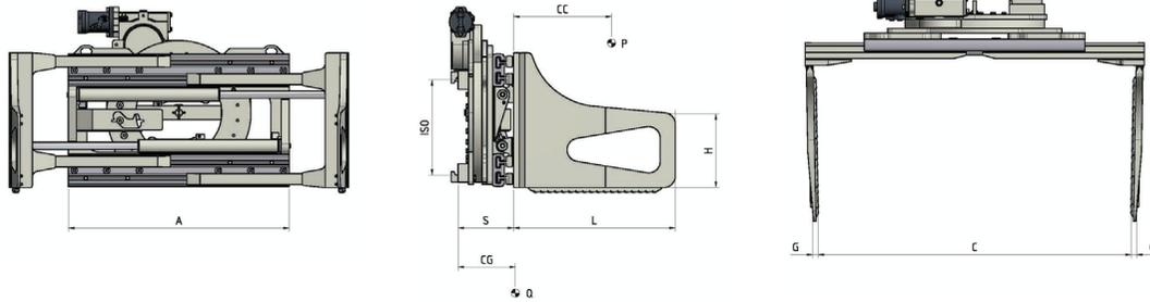
**ERFORDERLICHE HYDRAULIKFUNKTIONEN: 2 | MAXIMALER BETRIEBSDRUCK: 175 Bar**
