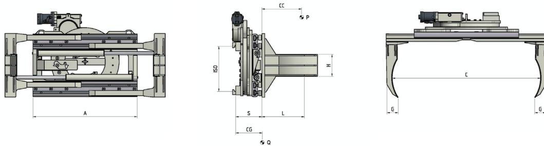
ERFORDERLICHE HYDRAULIKFUNKTIONEN: 2 | MAXIMALER BETRIEBSDRUCK: 175 Bar
