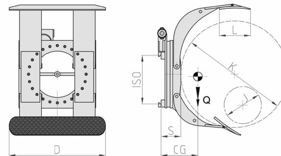
ERFORDERLICHE HYDRAULIKFUNKTIONEN: 2 | MAXIMALER BETRIEBSDRUCK: 175 Bar
