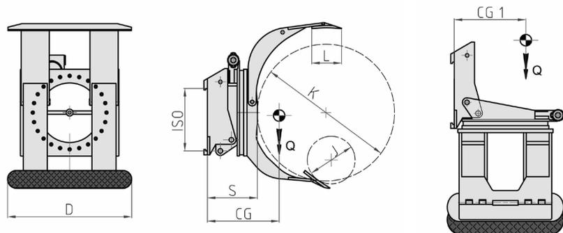
ERFORDERLICHE HYDRAULIKFUNKTIONEN: 3 | MAXIMALER BETRIEBSDRUCK: 175 Bar
