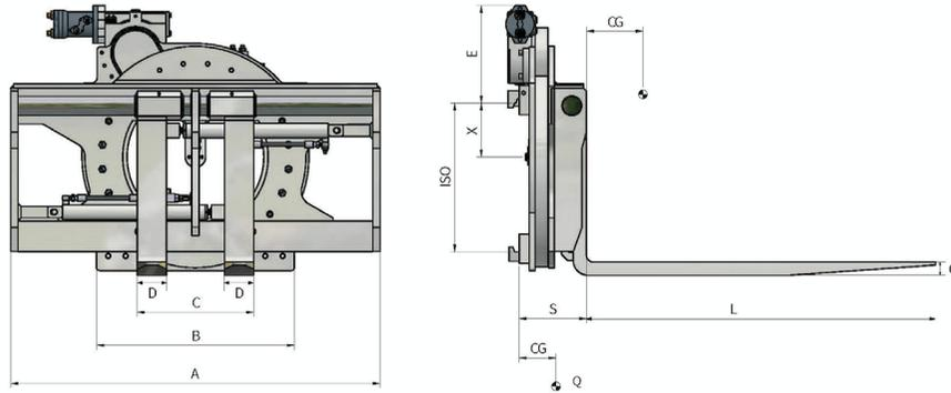
ERFORDERLICHE HYDRAULIKFUNKTIONEN: 2 | MAXIMALER BETRIEBSDRUCK: 175 Bar
