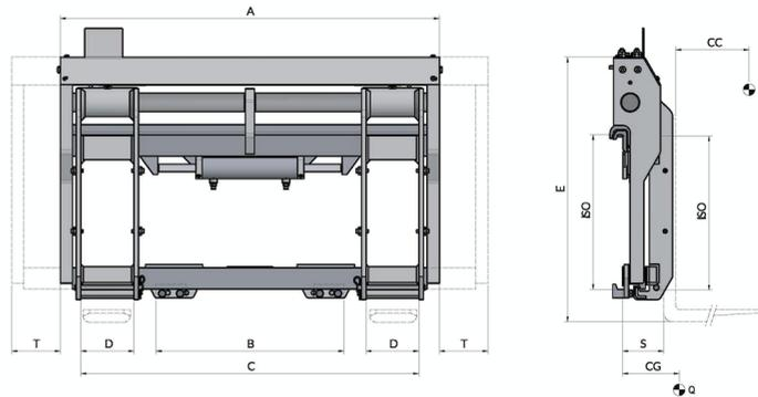
ERFORDERLICHE HYDRAULIKFUNKTIONEN: 2 | MAXIMALER BETRIEBSDRUCK: 110 Bar
