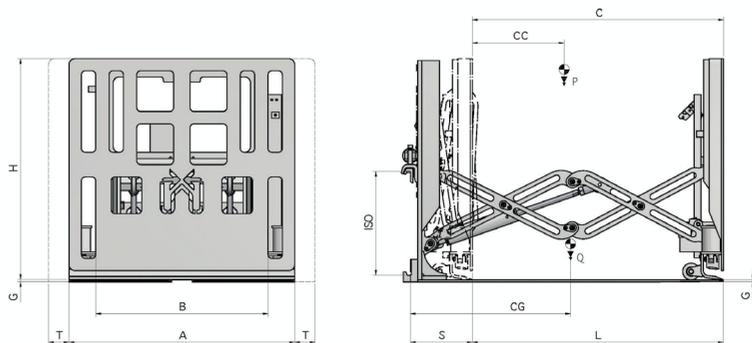
**ERFORDERLICHE HYDRAULIKFUNKTIONEN: 2 + ELEKTRISCH: 1 | MAXIMALER BETRIEBSDRUCK: 175 Bar**
