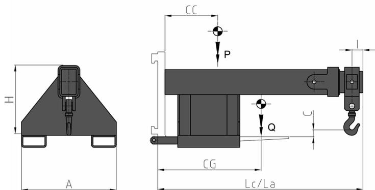
**Merkmale:** • Aufsteckbarer Anbaugerät. • Handling von hängenden Lasten. • Verwendung von Riemen oder Ketten.
