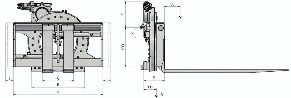
ERFORDERLICHE HYDRAULIKFUNKTIONEN: 3 | MAXIMALER BETRIEBSDRUCK: 175 Bar
