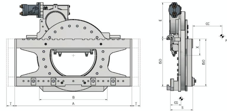
**ERFORDERLICHE HYDRAULIKFUNKTIONEN: 2 | MAXIMALER BETRIEBSDRUCK: 175 Bar**
