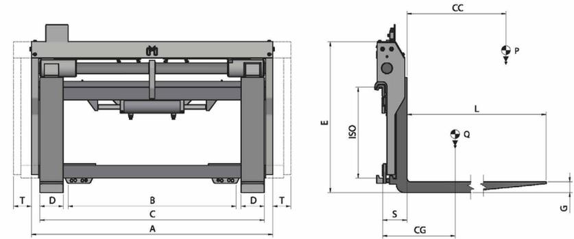
ERFORDERLICHE HYDRAULIKFUNKTIONEN: 2 | MAXIMALER BETRIEBSDRUCK: 110 Bar
