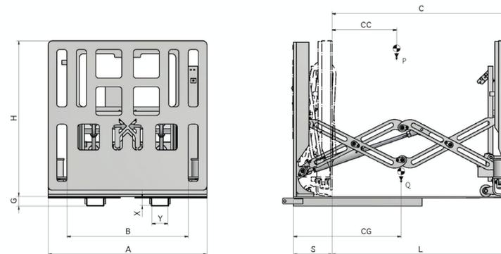
**ERFORDERLICHE HYDRAULIKFUNKTIONEN: 1 + ELEKTRISCH: 1 | MAXIMALER BETRIEBSDRUCK: 175 Bar**
