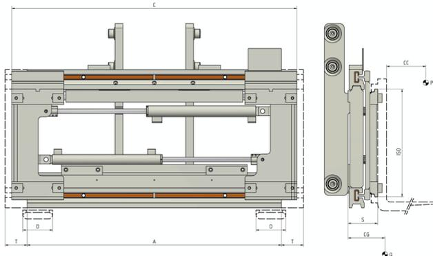
**ERFORDERLICHE HYDRAULIKFUNKTIONEN: 2 | MAXIMALER BETRIEBSDRUCK: 80 Bar**
