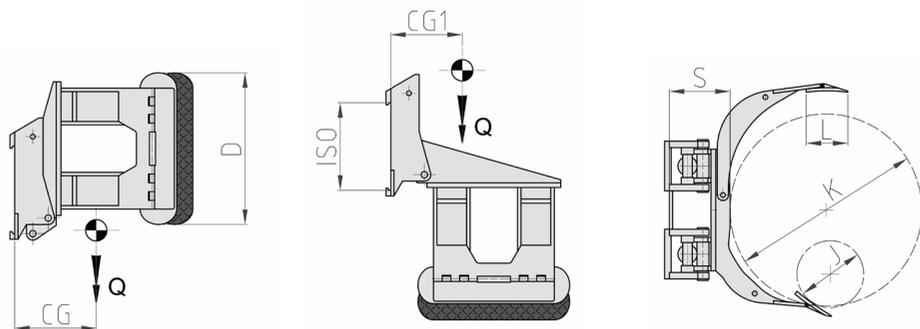
ERFORDERLICHE HYDRAULIKFUNKTIONEN: 2 | MAXIMALER BETRIEBSDRUCK: 175 Bar
