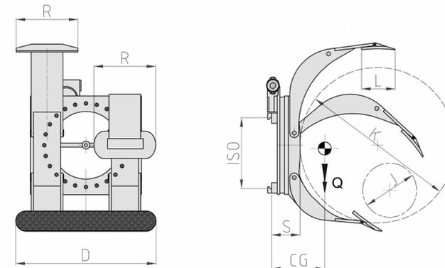
ERFORDERLICHE HYDRAULIKFUNKTIONEN: 2 | MAXIMALER BETRIEBSDRUCK: 175 Bar
