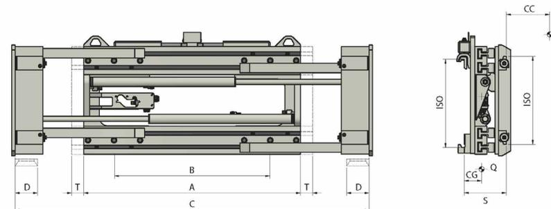
**ERFORDERLICHE HYDRAULIKFUNKTIONEN: 2 | MAXIMALER BETRIEBSDRUCK: 80 Bar**
