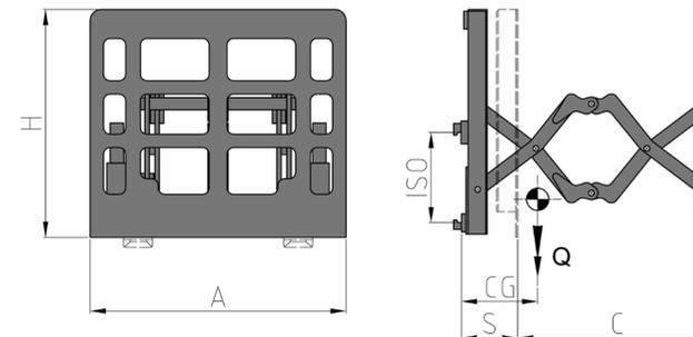
ERFORDERLICHE HYDRAULIKFUNKTIONEN: 1 | MAXIMALER BETRIEBSDRUCK: 175 Bar
