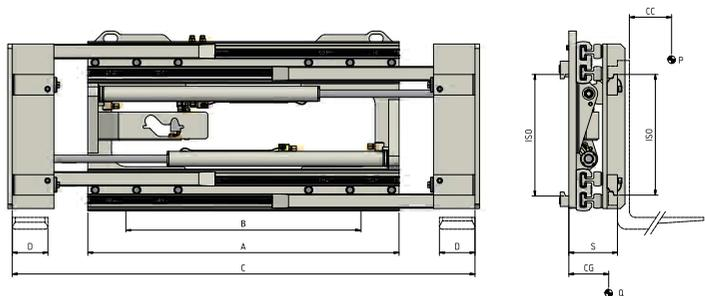
**ERFORDERLICHE HYDRAULIKFUNKTIONEN: 1 | MAXIMALER BETRIEBSDRUCK: 80 Bar**
