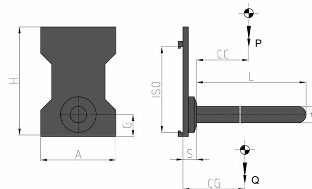
**Merkmale:** • Aufnahme von rohrförmigen Lasten, die längst zur Staplersachse liegen (Papierrollen, Fußmatten, Teppiche, Rohre aus Kunststoff, Zement oder Eisen, Walzdrahtrollen). • Montierbar auf Gabelträger des Staplers.
