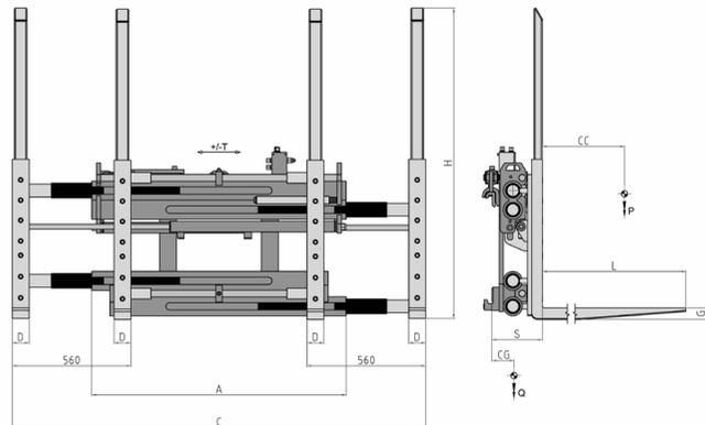
**ERFORDERLICHE HYDRAULIKFUNKTIONEN: 2 | MAXIMALER BETRIEBSDRUCK: 200 Bar**
