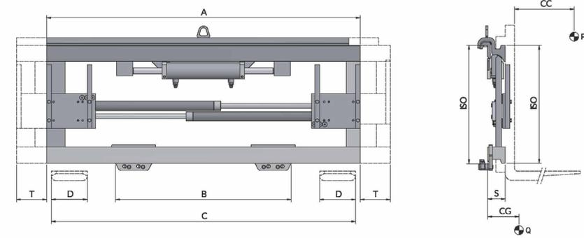
ERFORDERLICHE HYDRAULIKFUNKTIONEN: 2 | MAXIMALER BETRIEBSDRUCK: 110 Bar
