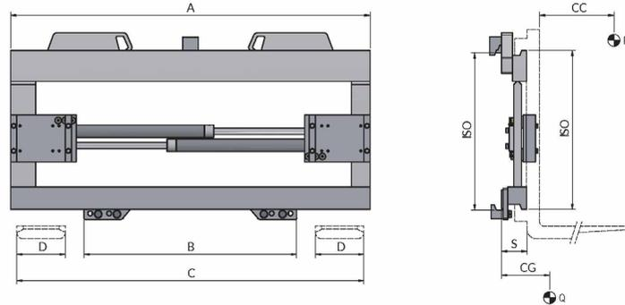
ERFORDERLICHE HYDRAULIKFUNKTIONEN: 1 | MAXIMALER BETRIEBSDRUCK: 110 Bar
