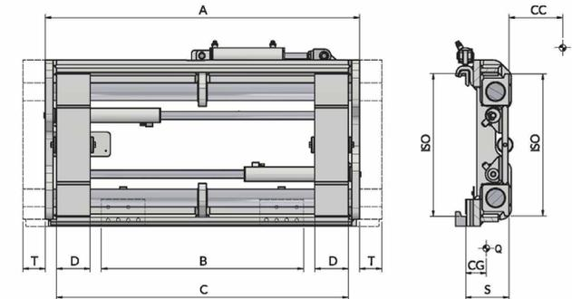
ERFORDERLICHE HYDRAULIKFUNKTIONEN: 2 | MAXIMALER BETRIEBSDRUCK: 80 Bar
