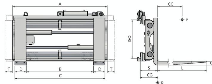
**ERFORDERLICHE HYDRAULIKFUNKTIONEN: 2 | MAXIMALER BETRIEBSDRUCK: 80 Bar**
