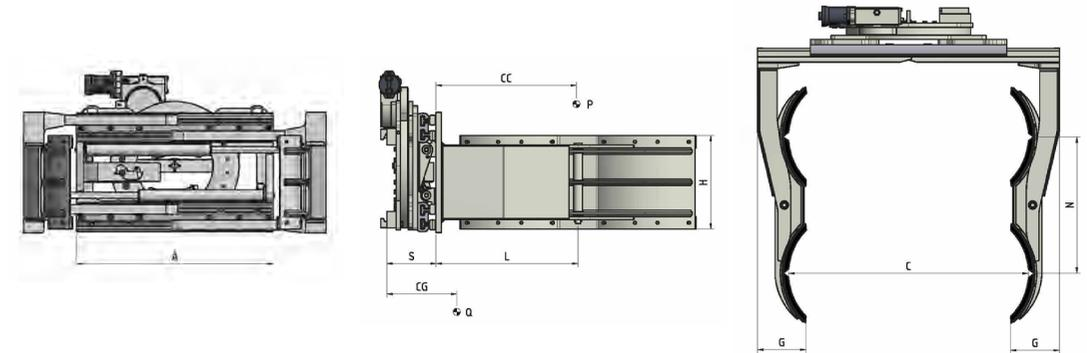
ERFORDERLICHE HYDRAULIKFUNKTIONEN: 2 | MAXIMALER BETRIEBSDRUCK: 175 Bar
