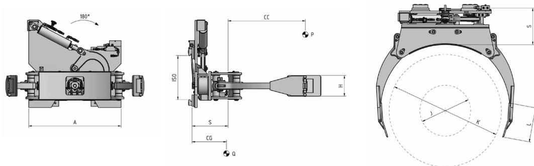
**ERFORDERLICHE HYDRAULIKFUNKTIONEN: 2 | MAXIMALER BETRIEBSDRUCK: 175 Bar**
