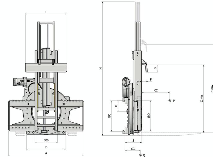
ERFORDERLICHE HYDRAULIKFUNKTIONEN: 2 | MAXIMALER BETRIEBSDRUCK: 175 Bar
