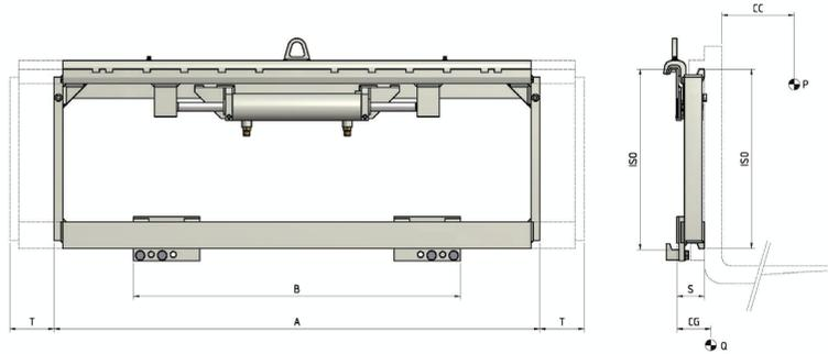
ERFORDERLICHE HYDRAULIKFUNKTIONEN: 1 | MAXIMALER BETRIEBSDRUCK: 200 Bar
