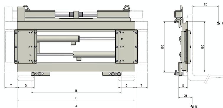
ERFORDERLICHE HYDRAULIKFUNKTIONEN: 2 | MAXIMALER BETRIEBSDRUCK: 80 Bar
