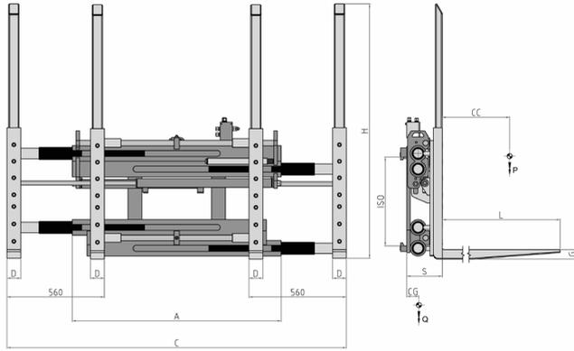
**ERFORDERLICHE HYDRAULIKFUNKTIONEN: 1 | MAXIMALER BETRIEBSDRUCK: 200 Bar**
