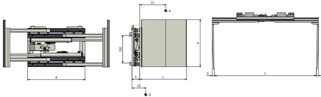
**ERFORDERLICHE HYDRAULIKFUNKTIONEN: 1 | MAXIMALER BETRIEBSDRUCK: 175 Bar**
