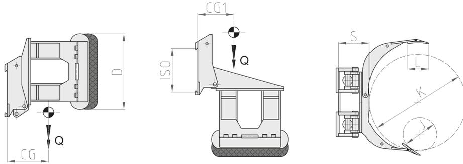
**FUNCIONES HIDRÁULICAS: 2 | PRESIÓN MÁX DE TRABAJO: 175 Bar**
