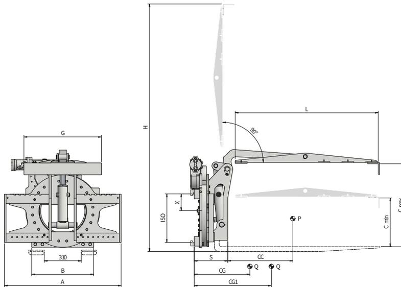
ERFORDERLICHE HYDRAULIKFUNKTIONEN: 2 | MAXIMALER BETRIEBSDRUCK: 175 Bar
