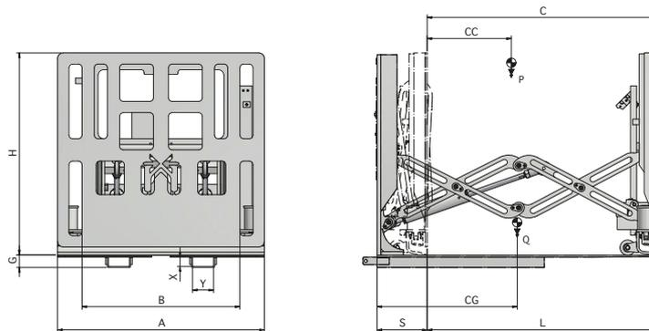
FUNCIONES HIDRÁULICAS: 1 + FUNCIONES ELÉCTRICAS: 1 | PRESIÓN MÁX DE TRABAJO: 175 Bar
