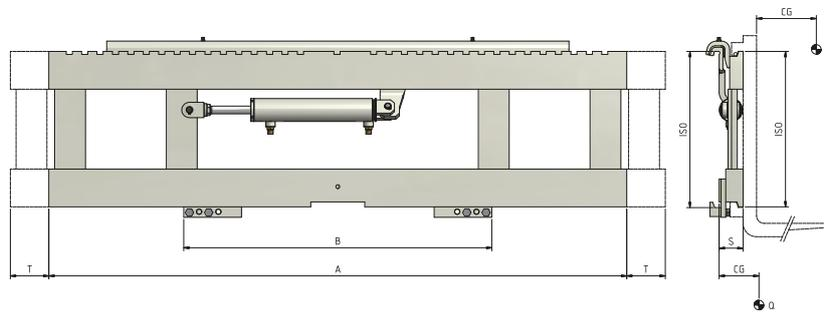
ERFORDERLICHE HYDRAULIKFUNKTIONEN: 1 | MAXIMALER BETRIEBSDRUCK: 200 Bar
