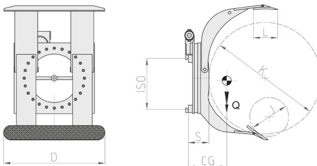
**FUNCIONES HIDRÁULICAS: 2 | PRESIÓN MÁX DE TRABAJO: 175 Bar**
