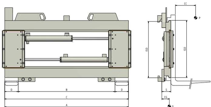
ERFORDERLICHE HYDRAULIKFUNKTIONEN: 1 | MAXIMALER BETRIEBSDRUCK: 80 Bar
