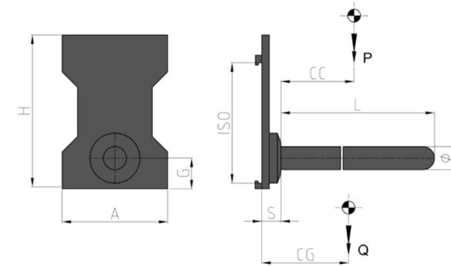
**Merkmale:** • Aufnahme von rohrförmigen Lasten, die längst zur Staplersachse liegen (Papierrollen, Fußmatten, Teppiche, Rohre aus Kunststoff, Zement oder Eisen, Walzdrahtrollen). • Montierbar auf Gabelträger des Staplers.
