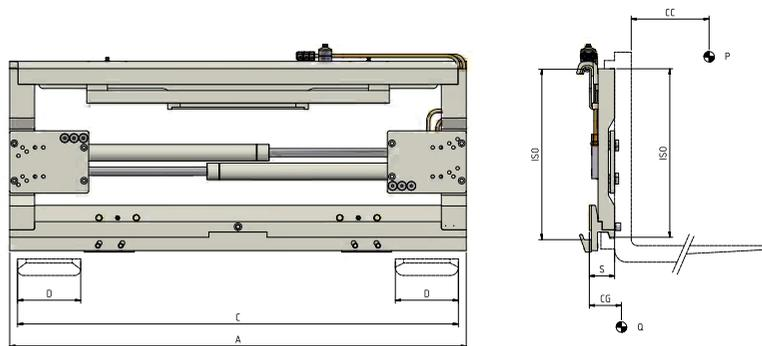
ERFORDERLICHE HYDRAULIKFUNKTIONEN: 1 | MAXIMALER BETRIEBSDRUCK: 110 Bar
