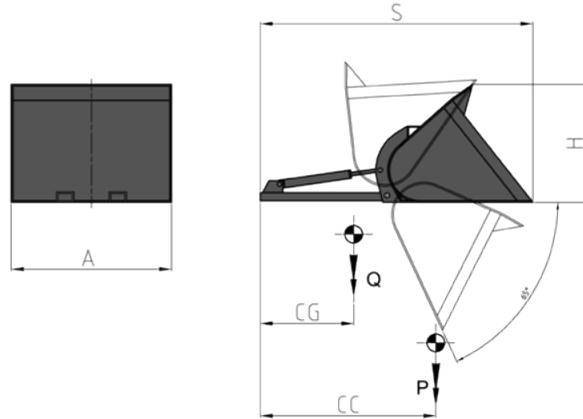
ERFORDERLICHE HYDRAULIKFUNKTIONEN: 1 | MAXIMALER BETRIEBSDRUCK: 175 Bar
