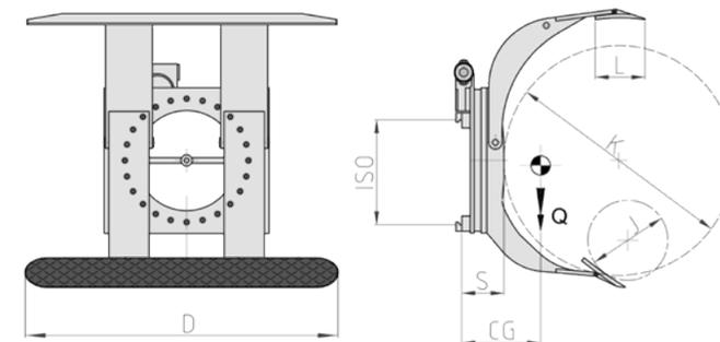
**ERFORDERLICHE HYDRAULIKFUNKTIONEN: 2 | MAXIMALER BETRIEBSDRUCK: 175 Bar**
