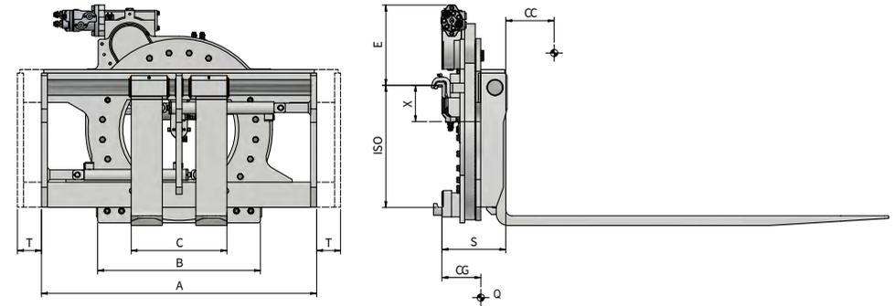
ERFORDERLICHE HYDRAULIKFUNKTIONEN: 3 | MAXIMALER BETRIEBSDRUCK: 175 Bar
