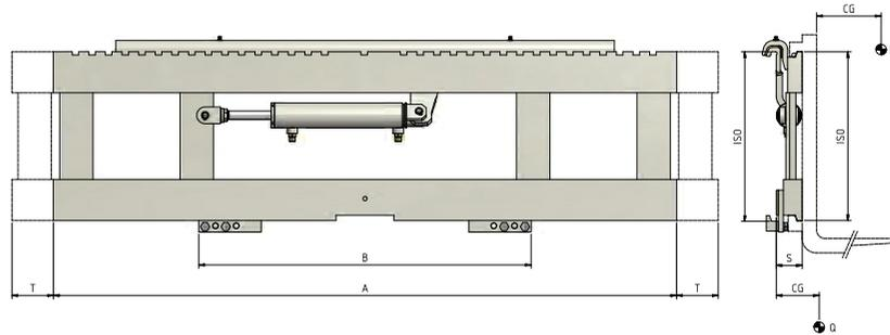
**ERFORDERLICHE HYDRAULIKFUNKTIONEN: 1 | MAXIMALER BETRIEBSDRUCK: 200 Bar**
