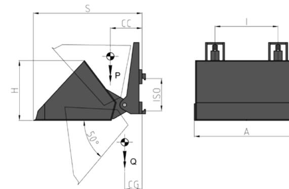
ERFORDERLICHE HYDRAULIKFUNKTIONEN: 1 | MAXIMALER BETRIEBSDRUCK: 175 Bar
