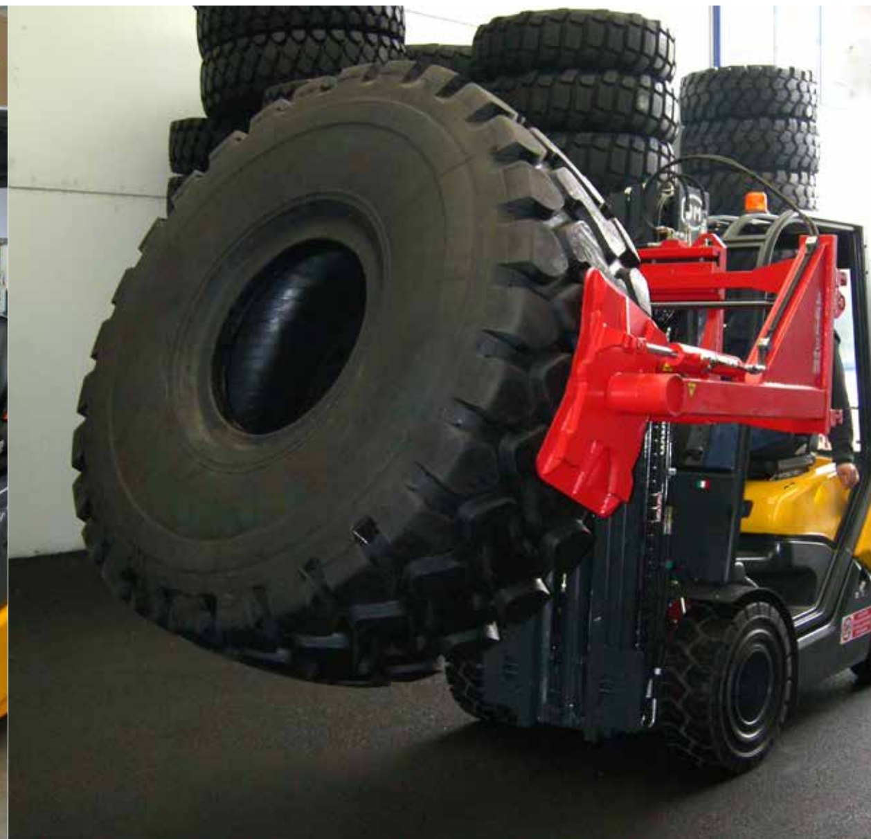
Pinza per Pneumatici con Ganasce con Ribaltamento Frontale di 90°
