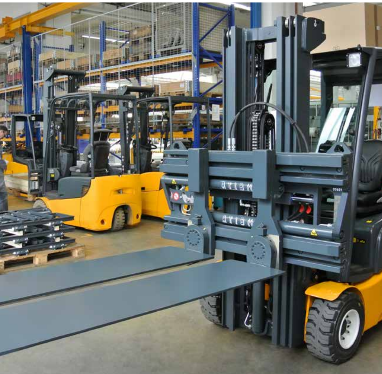
Pinza a Forche Rotanti 90° con Calzatoie Piane Lisce
