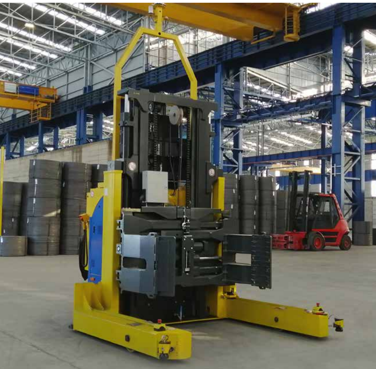
Montante Duplex con Pinza per Bobine per Macchine AGV
