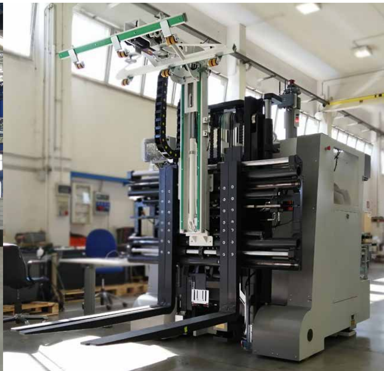
Montante Triplex con Doppio Posizionatore Forche per Macchine AGV
