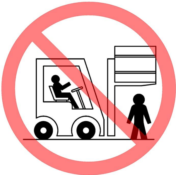
Non passare sotto il carico
