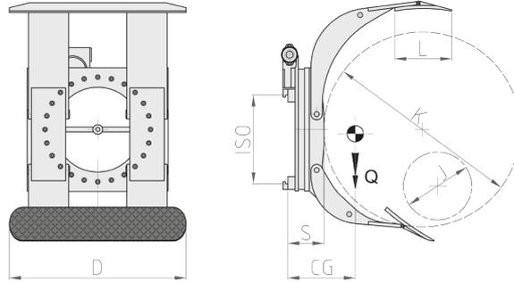
**FUNZIONI IDRAULICHE: 2 | PRESSIONE MAX DI ESERCIZIO: 175 Bar**
