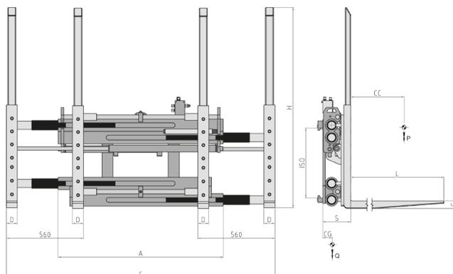
FUNZIONI IDRAULICHE: 1 | PRESSIONE MAX DI ESERCIZIO: 200 Bar
