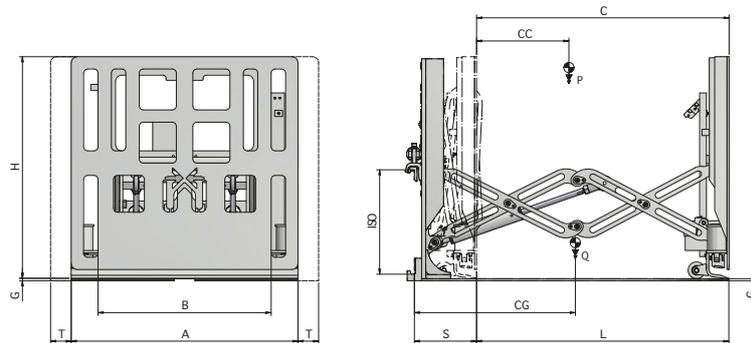
FUNZIONI IDRAULICHE: 2 + FUNZIONI ELETTRICHE: 1 | PRESSIONE MAX DI ESERCIZIO: 175 Bar
