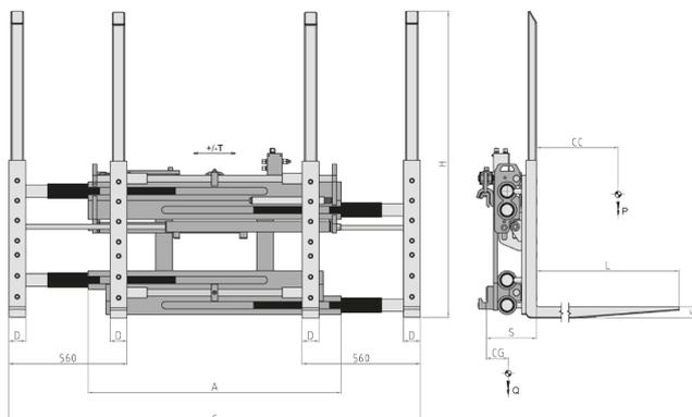
FUNZIONI IDRAULICHE: 2 | PRESSIONE MAX DI ESERCIZIO: 200 Bar
