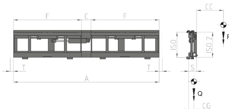
Funzioni idrauliche: 2 | Pressione max di esercizio: 200 Bar
