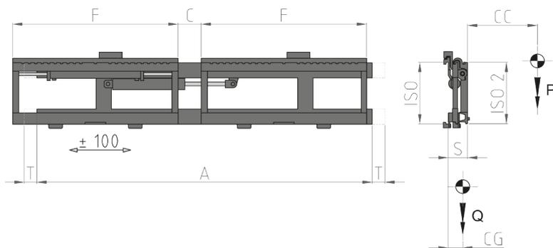
Funzioni idrauliche: 2 | Pressione max di esercizio: 200 Bar
