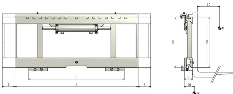
FUNZIONI IDRAULICHE: 1 | PRESSIONE MAX DI ESERCIZIO: 200 Bar
